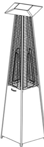
10. Ξεβιδώστε το χερούλι (18) μέσα από το μπροστά πλαίσιο (16), συνδέστε το σύνδεσμο (12) πίσω από το μπροστά πλαίσιο, βιδώστε τα με 2 μπουλόνια M4X8, κρεμάστε την αλυσίδα (19) στη τρύπα στο κιβώτιο ελέγχου, και έπειτα κλείστε το πλαίσιο στη μεσαία πλάκα. Το πλαίσιο έλκεται από τους μαγνήτες.
